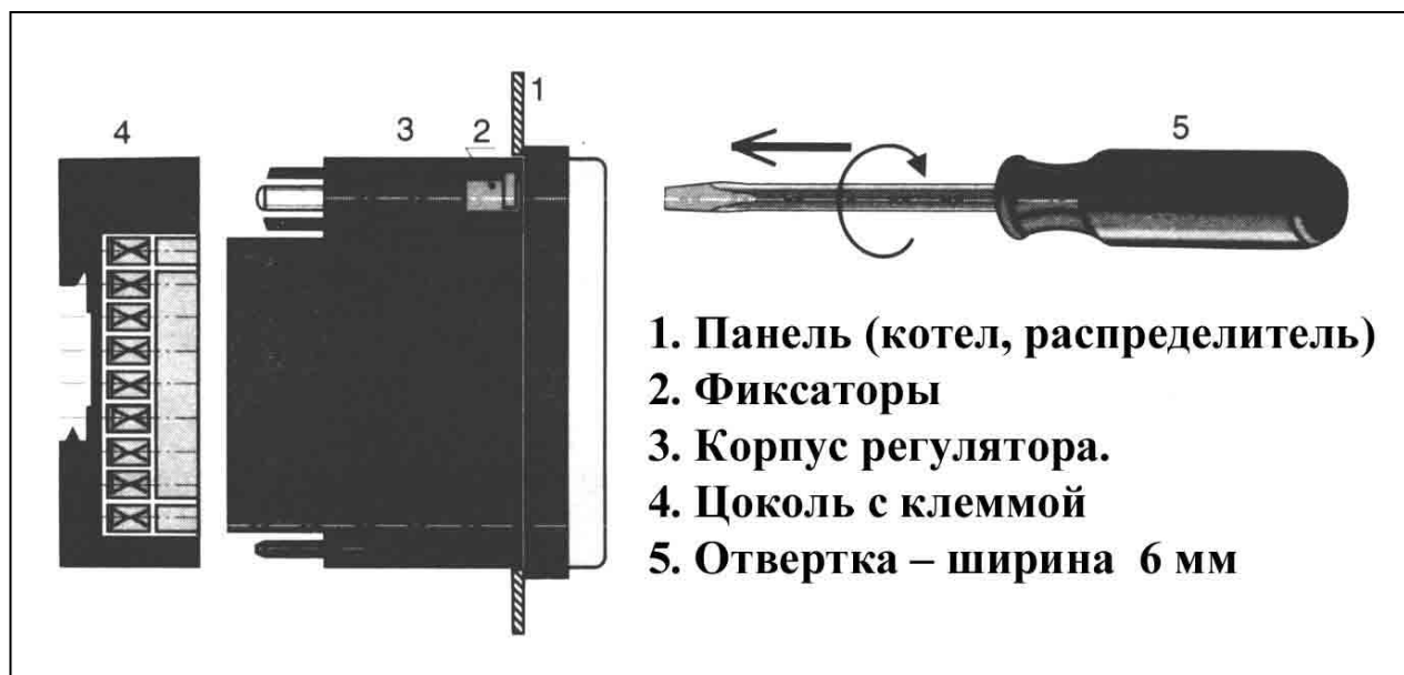
Рис. №5 - монтаж регулятора к панели
